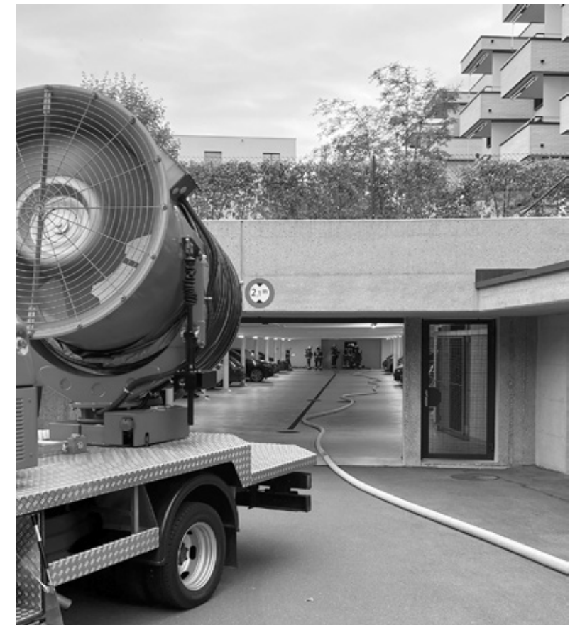
Dieser Grosslüfter erzeugt Überdruck und drückte den Rauch aus der Büttenenring-Tiefgarage raus. Feuerwehr der Stadt Luzern
